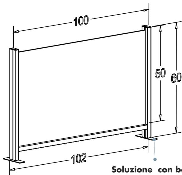
**Soluzione con base in lamiera cm 15x4 spessore 3 mm. La base è dotata di due fori per il fissaggio diretto sul top.**
